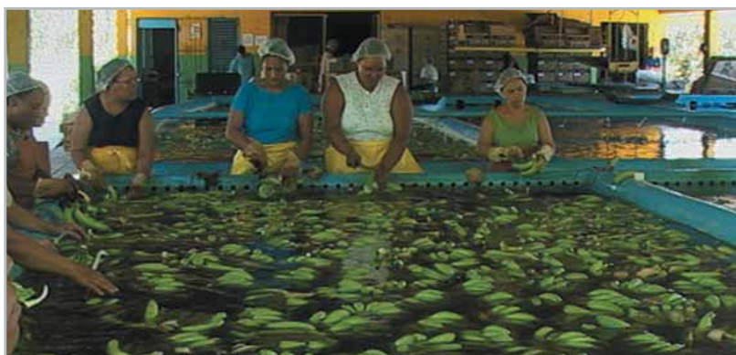
Figura 25. Tina de selección de frutas donde se eliminan defectos y se seccionan las "manos" en gajos. Detrás de las selectoras se observan las tinas de "desleche".
