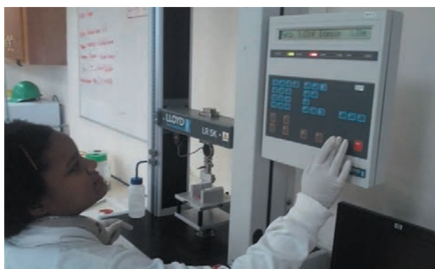
Fotografía 17. Texturómetro utilizado para medir el esfuerzo al corte.
