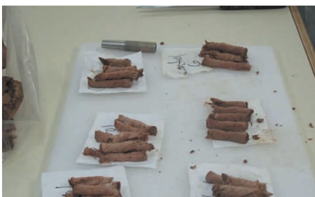
Fotografía 18. Imagen de muestras extraídas con sacabocados de 1/2 pulgada para colocarlas en la cuchilla de Waner Blazer.
