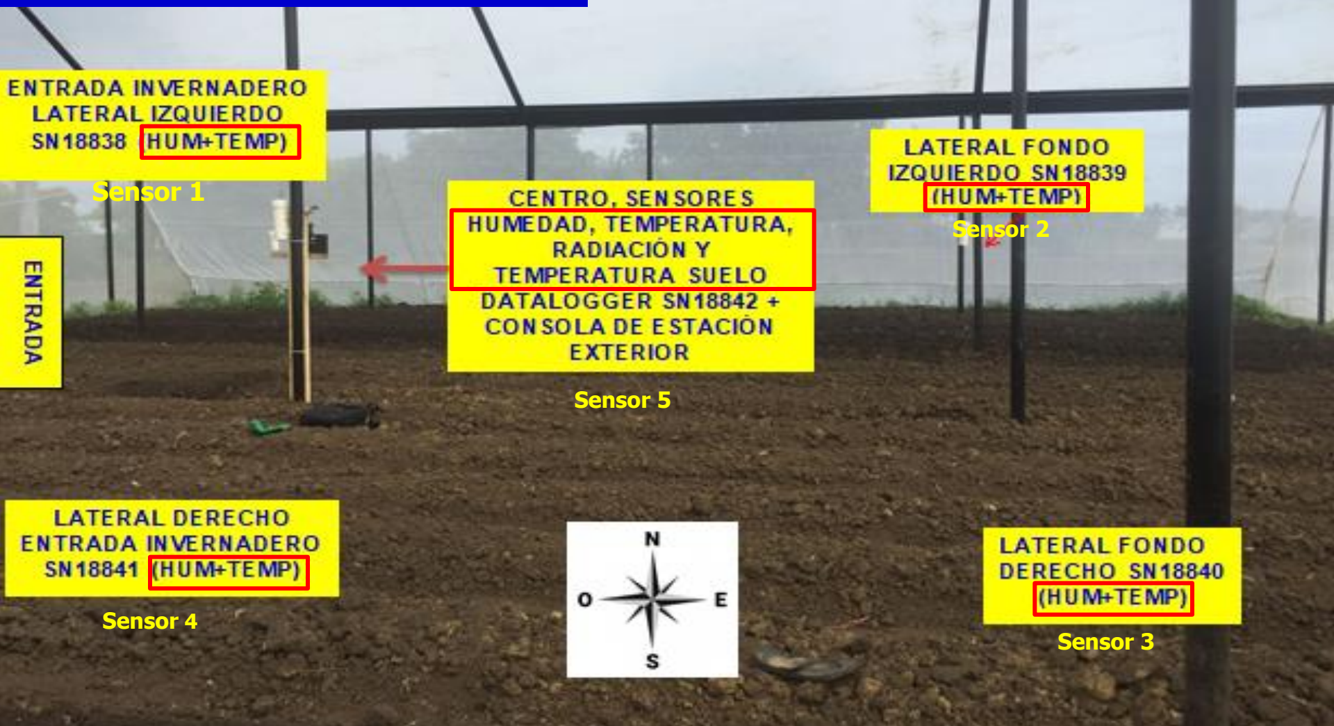
Figura 5. Distribución de los Data Logger para el registro de las condiciones micro-climáticas dentro de la estructura protegida híbrida. Fuente propia, 2021.
